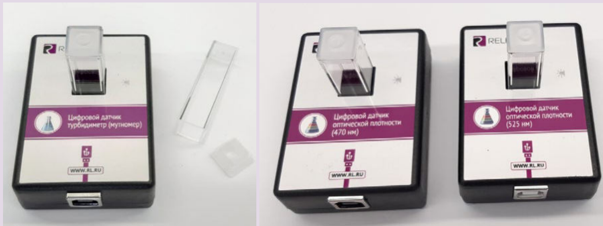
Рис. 8. Датчики мутности (слева), оптической плотности на 465 нм (в центре) и 525 нм (справа)
