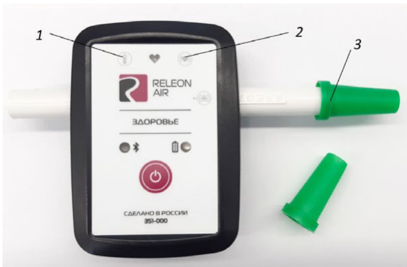
Рис. 3. Мультидатчик по физиологии. Обозначение разъёмов и технологических отверстий: 1 — температура тела, 2 — пульс, 3 — частота дыхания (надет съёмный мундштук)
