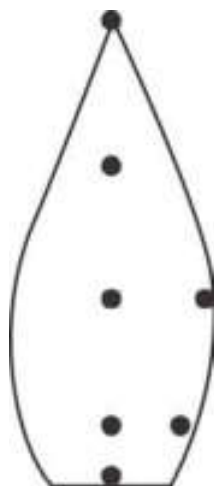
Рис. 1. Точки измерения температуры пламени
