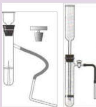
Рис. 7. Прибор для получения и собирания газов
