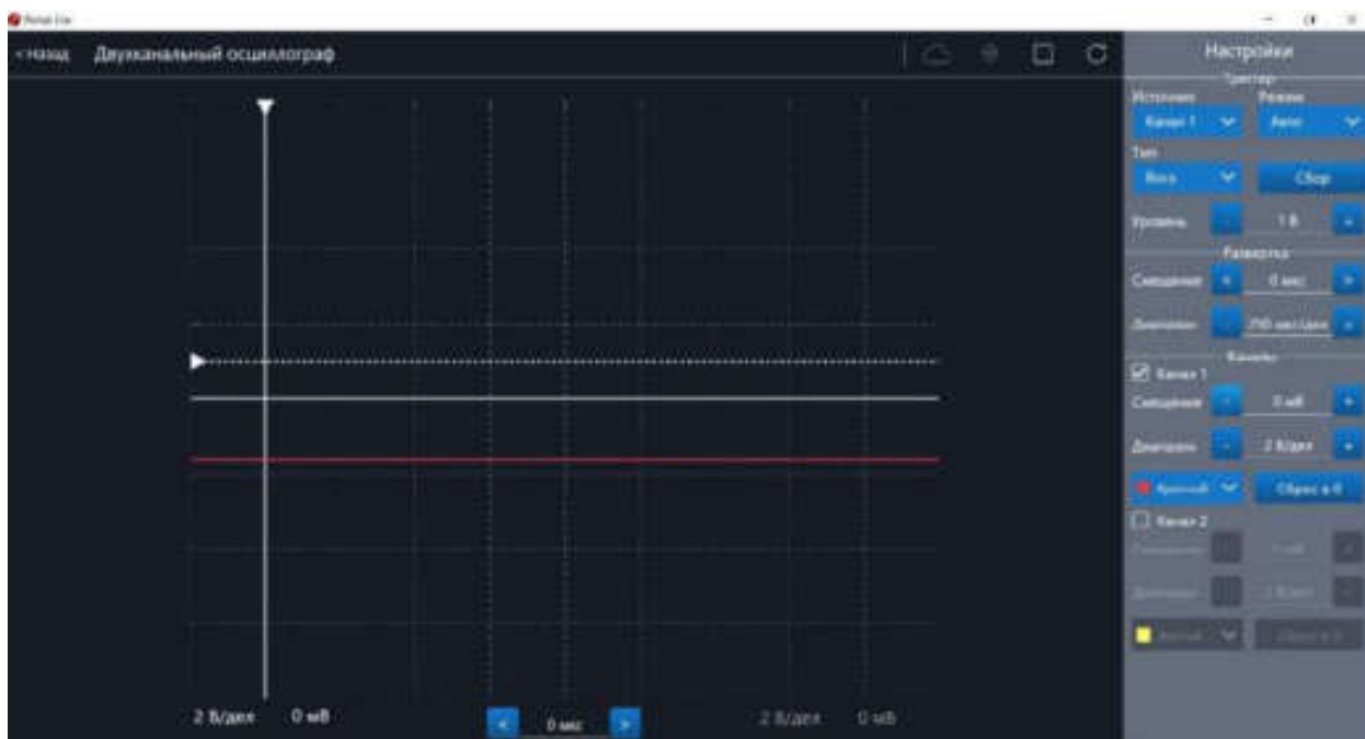
Рис. 40. Сигнал с ненулевым смещением
